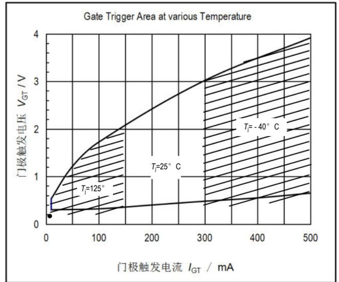
图10. 不同结温下的门极触发区
